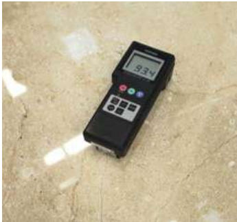
Light reflectance values up to 90 on a scale of 100. Valores de brillo de hasta 90 en una escala de 100.
